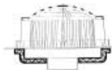
Isolasjonsskål NRF 340 24 72 Forhindrer kondens. Diff. tett.
